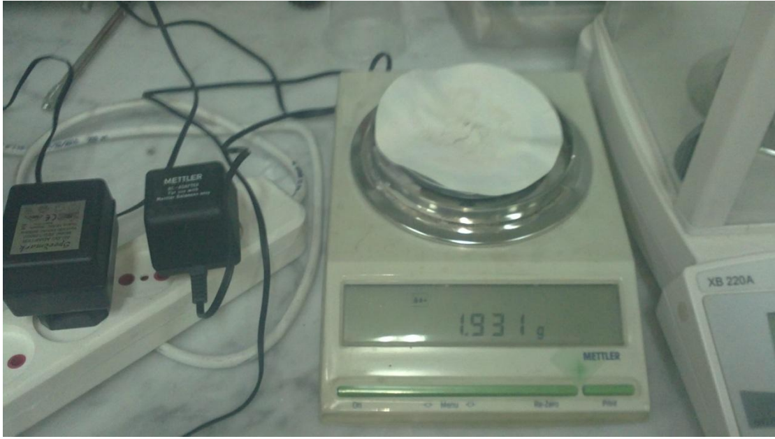
الصورة ( 19 ) نواتج الحرق بعد ثبات الوزن.
