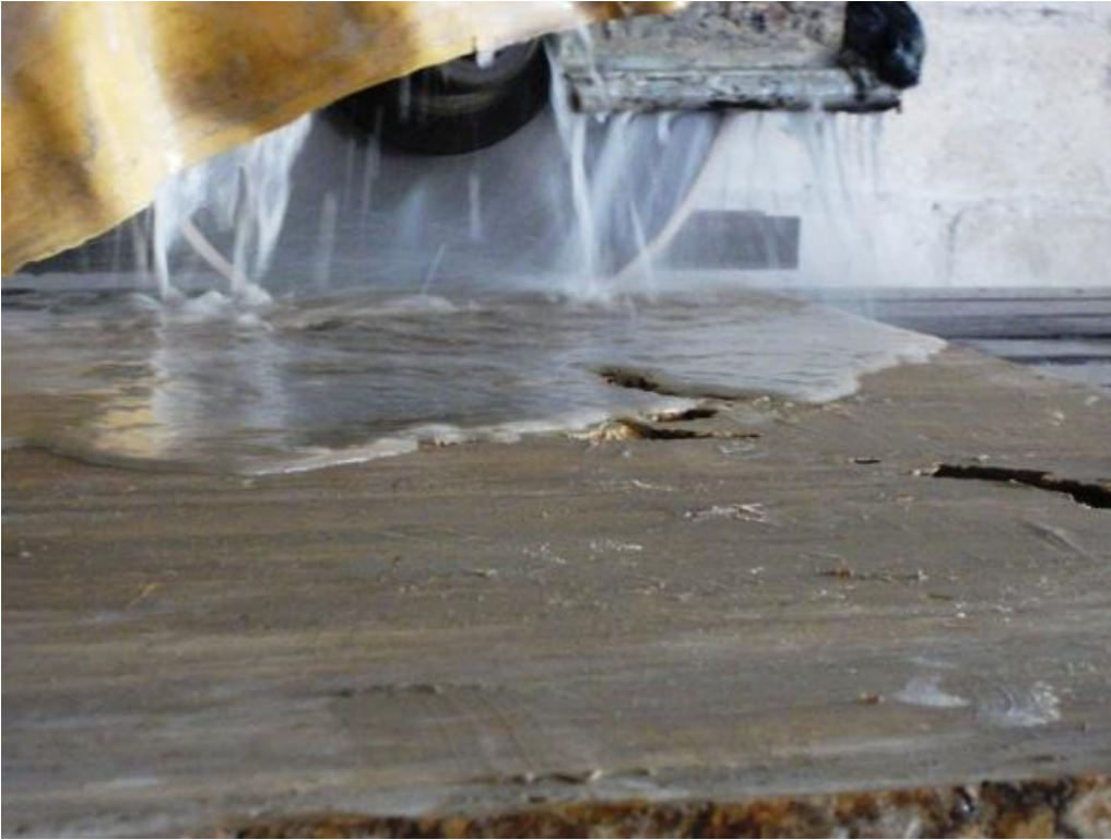
الصورة ( 24 ) استخدام المياه المعادة في تبريد آليات القص.
