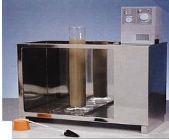
الصورة ( 21 ) تجربة الهيدروميتر.
